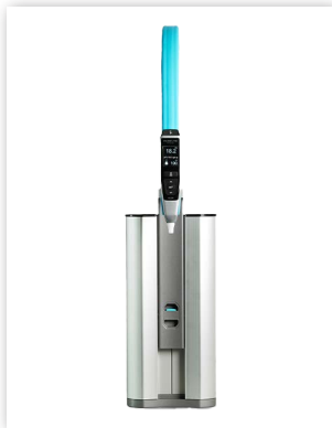
PURELAB FLEX 1 Lámpara UV 185/254 nm para producción de agua con bajo nivel TOC, requerida en aplicaciones orgánicas sensibles
