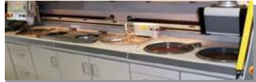
SPECTRAL MMMax Preparación de aceros, hierro fundido y metales no ferrosos para OES y XRF Unidad de control: PLC Siemens Touch screen HMI de 10 pulgadas
