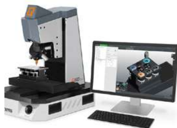
Modelo: Q30 (0,100 - 31.25kg) Tipo de Bastidor: M version Software / PC : Qpix T2
